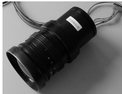
图 2 基于 BF561 DSP 的非制冷 IRFPA 组件
